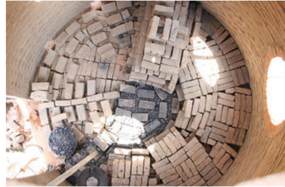
Resim 24. Yanma işleminin gerçekleşmesini sağlayacak hava dolaşımına olanak sağlayan fırın (konut) içerisinde kümelenmiş tuğla ürünler (Kaynak: Andres Herzog, 2011, https://archnet.org/sites/15691 ).
