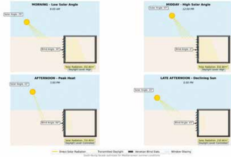
Şekil 2. Gün Boyunca Otomatik Venedik Stor İşleyişi / Kuzey Kıbrıs'ta Güneye Bakan Cephe (Yazar, 2025)
