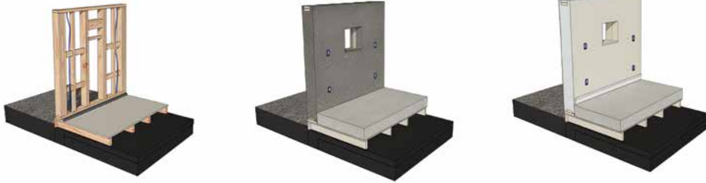
Şekil 2: Ölçeksiz kenevir betonu kesit tipolojileri. Şekil 3: Üç boyutlu kenevir betonu görseli.
