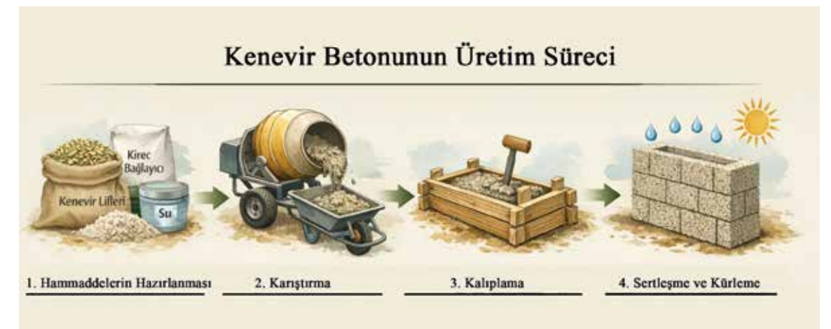
Şekil 1: Kenevir betonunun üretim süreci.
