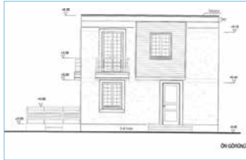
Şekil 3. Kerpiç+hafif çelik karma yapı Projesi, giriş cephesi.
